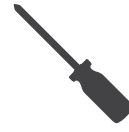
プラスドライバー (先端：#1 軸：Φ5以下 で長さがあるもの)
